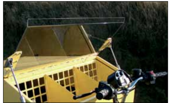
Väderskyddet i uppfällt läge fungerar som vindskydd åt föraren.
