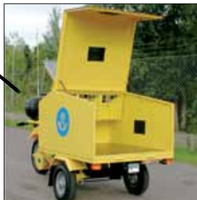
Väderskyddet i uppfällt läge fungerar som vindskydd åt föraren.
